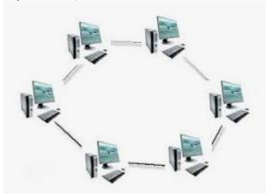
Şəkil 10.2. Halqavari topologiya
