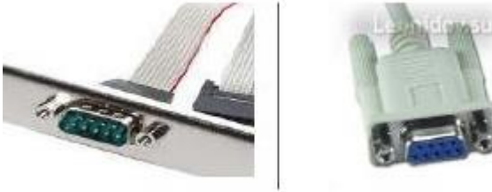
Şəkil 2.24. solda COM portu, sağda isə onun kabeli
