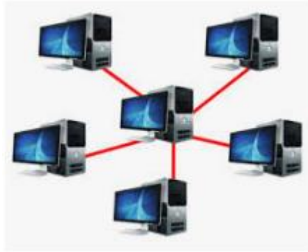
Şəkil 10.3. Ulduzvari topologiya
