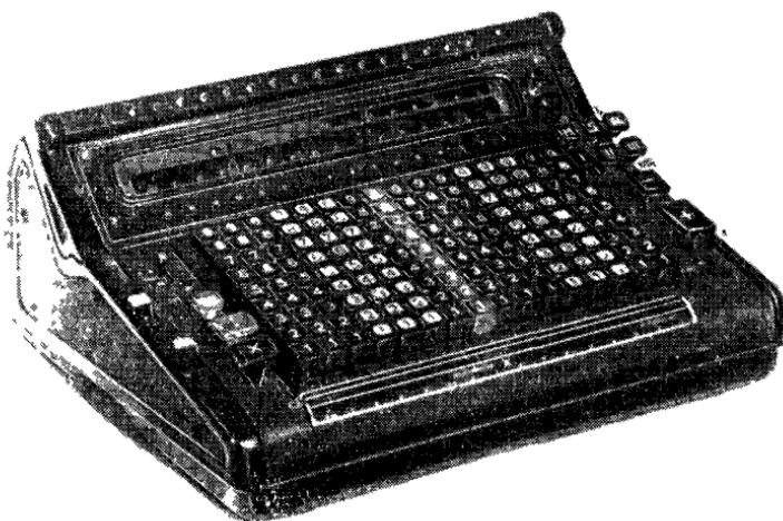
Рис. 6. Клавишиная вычислительная машина «Мерседес».
