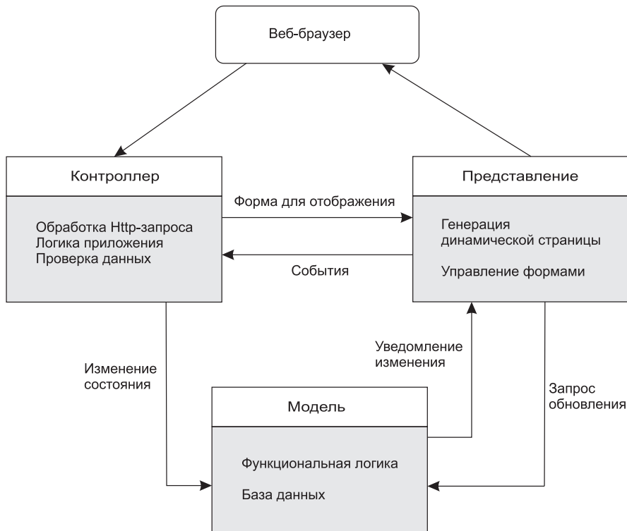
Рис. 6.4. Архитектура веб-системы на основе паттерна модель-представление-контроллер
