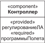
Рис. 10.10. Описание интерфейсов в прямоугольнике компонента
