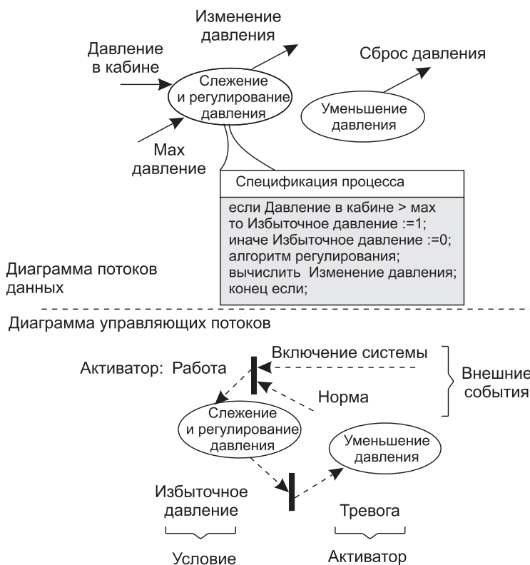
Рис. 5.9. Модель системы регулирования давления космического корабля
