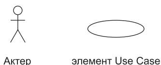
Рис. 9.1. Обозначения актера и элемента Use Case
