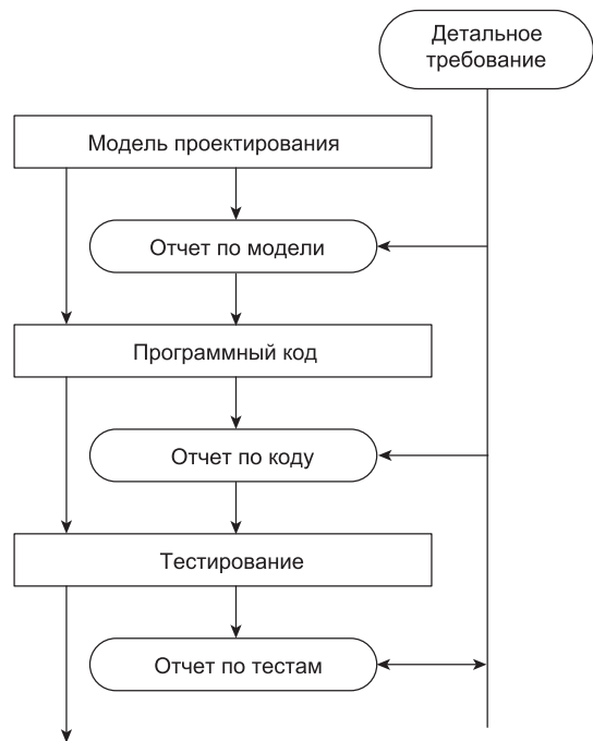
Рис. 4.2. Прослеживание детального требования (стрелки показывают связи прослеживания)
