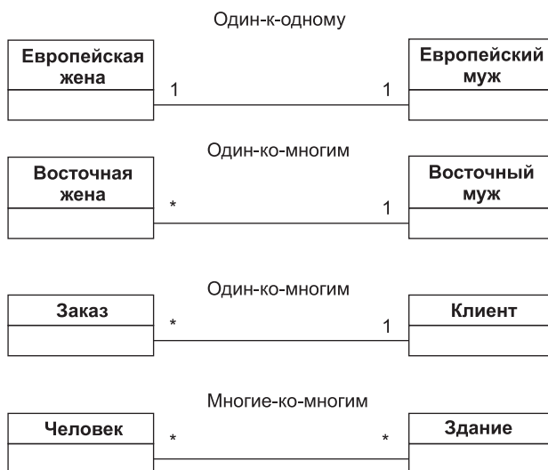
Рис. 8.11. Ассоциации с различными типами мощности
