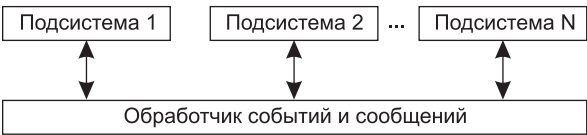
Рис. 6.13. Система широковещательного управления
