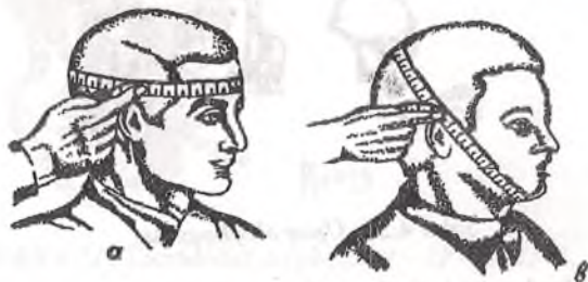
Şəkil 4.19. Süzücü əleyhqaz QP-7-nin üzlük hissəsinin seçilməsi; a) üfüqi; b) şaquli.
