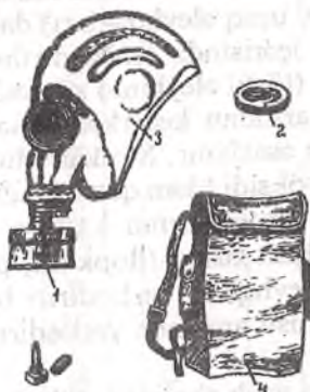
Şəkil 4.16. Süzücü əleyhqaz – QP-5:1 – əleyhqaz qutusu; 2 – tərleməyən plyonkalar olan qutu; 3 – şlem-maskə; 4 – çanta.
