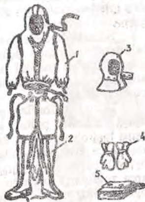
Şəkil 4.23. Yüngül mühafizə kostyumu -- L-1; 1 - gödəkçə başlıqla; 2 - şalvar corabla; 3 - başlıqaltı; 4 - əlcək; 5 - torba.
